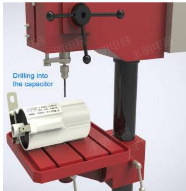
H.V CAPACITOR/CBB85 电容进行机械钻孔破坏
